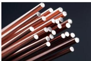
铜磷钎料是以铜、磷为主要元素的合金钎料，钎料流动性好，钎焊温度较低并具备自钎作用，焊接纯铜时可在通常气氛下施焊而无需钎剂，适用于铜及铜合金的电阻钎焊、火焰焊和感应钎焊等焊接方法。因磷元素易与铁生成脆性化合物，铜磷钎料不建议用于黑色金属的钎焊。
